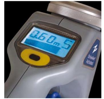
En mode 'Sonde/CPS', les sondes ou les réseaux sous protection cathodique (CPS) sont détectés.
