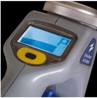
En mode P, Le SuperC.A.T détecte le signal 50 Hz émis par les câbles en charge.
