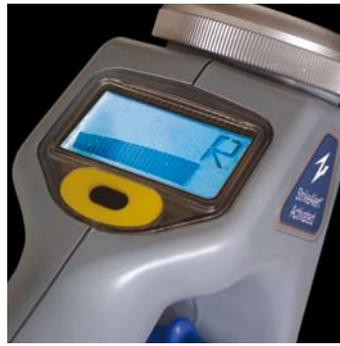
En mode R, le SuperC.A.T détecte les signaux radio de très basses fréquences (VLF) relayés par les tuyaux métalliques et les câbles enterrés.
